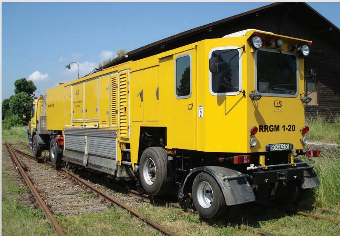
Die RRG 1-20 ist eine mobile Schienenschleifmaschine mit Zweiwegetechnik. Die Anlage verfügt über 20 unabhängig voneinander winkeleinstellbare Schleifmotoren, die mit je 7,5 bis 15kW frequenzgesteuerten Elektromotoren angetrieben werden. Der computergesteuerte Schleifprozess wird mittels Bildschirm vom Bediener überwacht.
