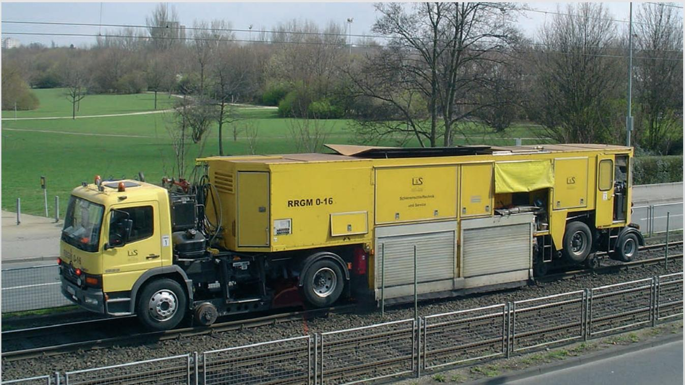
Die RRG 0-16 ist eine mobile Schienenschleifmaschine mit Zweiwegetechnik. Die Anlage verfügt über 16 unabhängig voneinander winkeleinstellbare Schleifmotoren, die mit je 7,5 kW frequenzgesteuerten Elektromotoren angetrieben werden. Der computergesteuerte Schleifprozess wird mittels Bildschirm vom Bediener überwacht.
