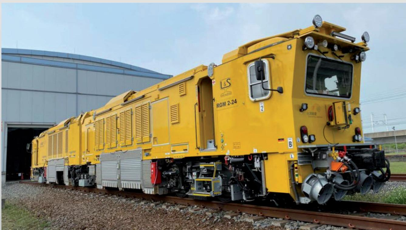
Die RGM 2-24 ist eine mobile gleisgebundene Schienenschleifmaschine, bestehend aus zwei Wageneinheiten. Die Anlage verfügt über 24 unabhängig voneinander einstellbare Schleifmotoren, die mit frequenzgesteuerten Elektromotoren angetrieben werden. Der computergesteuerte Schleifprozess wird mittels Bildschirmen in den Kabinen vom Bediener überwacht.
