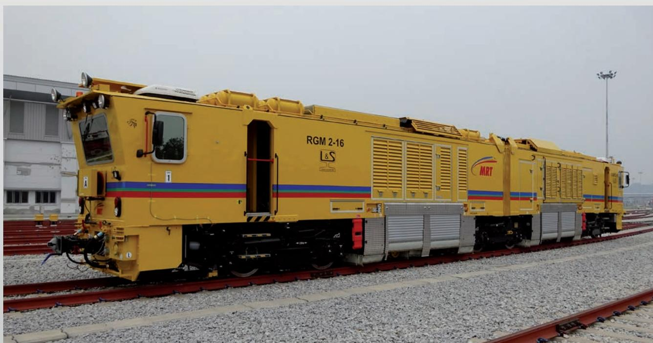
Bei der RGM 2-16 handelt es sich um eine mobile gleisgebundene Schienenschleifmaschine, bestehend aus zwei Wageneinheiten. Die Anlage verfügt über 16 unabhängig voneinander einstellbare Schleifmotoren, die mit frequenzgesteuerten Elektromotoren angetrieben werden. Der computergesteuerte Schleifprozess wird mittels Bildschirmen in den Kabinen vom Bediener überwacht.
