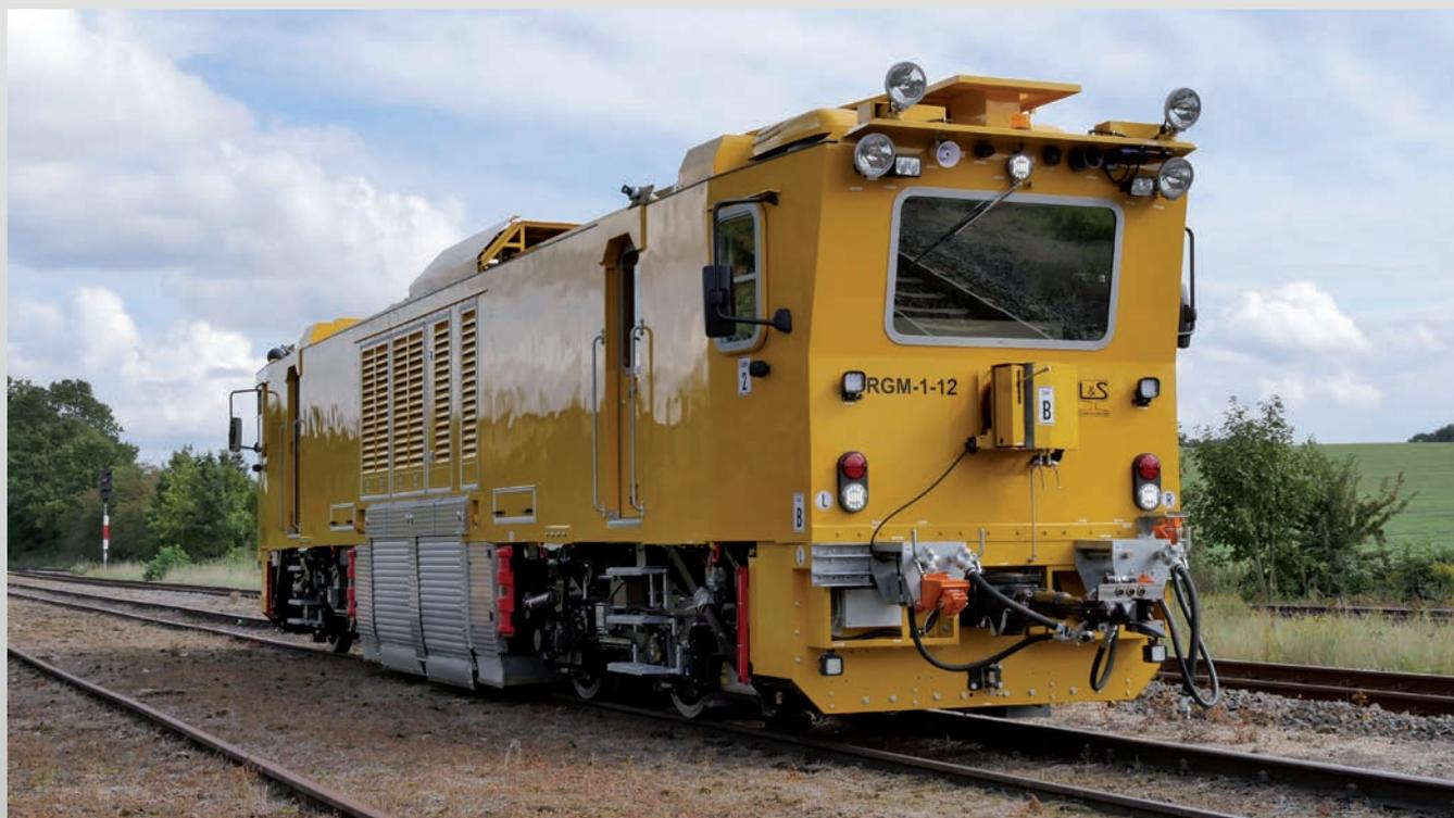
Bei der RGM 1-12 handelt es sich um eine mobile gleisgebundene Schienenschleifmaschine. Die Maschine verfügt über 12 unabhängig voneinander winkeleinstellbare Schleifmotoren, die mit frequenzgesteuerten Elektromotoren angetrieben werden. Der computergesteuerte Schleifprozess wird mittels Bildschirm vom Bediener überwacht.
