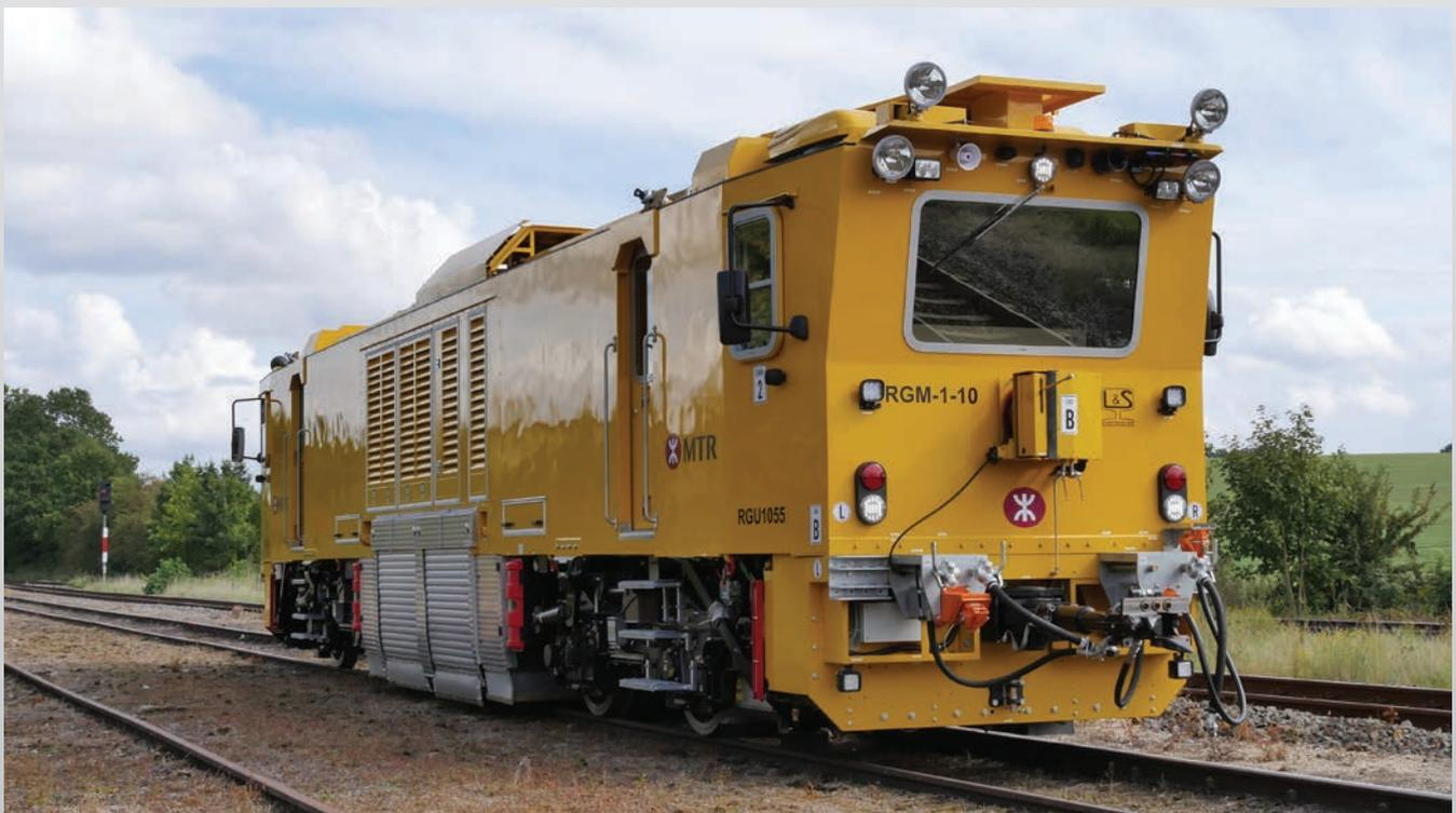
Bei der RGM 1-10 handelt es sich um eine mobile gleisgebundene Schienenschleifmaschine. Die Maschine verfügt über 10 unabhängig voneinander winkeleinstellbare Schleifmotoren, die mit frequenzgesteuerten Elektroantrieben gesteuert werden. Der computergesteuerte Schleifprozess wird mittels Bildschirm vom Bediener überwacht.
