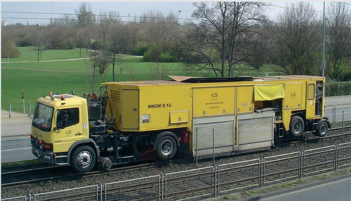
Die RRG 0-16 ist eine mobile Schienenschleifmaschine mit Zweiwegetechnik. Die Anlage verfügt über 16 unabhängig voneinander winkeleinstellbare Schleifspindeln, die mit je 7,5 kW frequenzgesteuerten Elektromotoren angetrieben werden. Der computergesteuerte Schleifprozess wird mittels Bildschirm vom Bediener überwacht.
